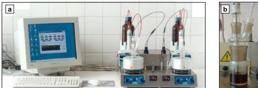
El Analizador SHELL/ZEMATRA consta de dos celdas de reacción de vidrio resistentes a altas temperaturas, con entradas para el sensor óptico (optrode) y el dosificador de titulante (Dosimat) (Figura 18.b). Cada celda está recubierta con una chaqueta térmica que tiene un sistema de control que permite fijar temperaturas hasta 150°C.
