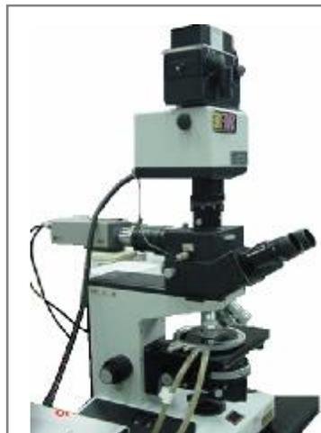
El microscopio Leitz Diaplan (Figura 25) provisto con una cámara filmadora, un monitor y un lente  $L40/0.60$  permite distinguir partículas desde  $1\mu\text{m}$ , gotas de agua emulsionada dentro del crudo, parafinas, cristales de ceras,
