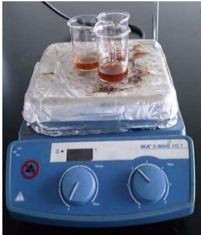
*Figura H5:* Montaje experimental tratamiento con resina aniónica fuerte en operación batch
