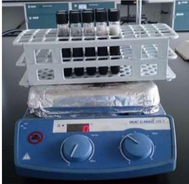
Figura H1: Montaje experimental adsorción sólido-líquido usando carbón activado.
