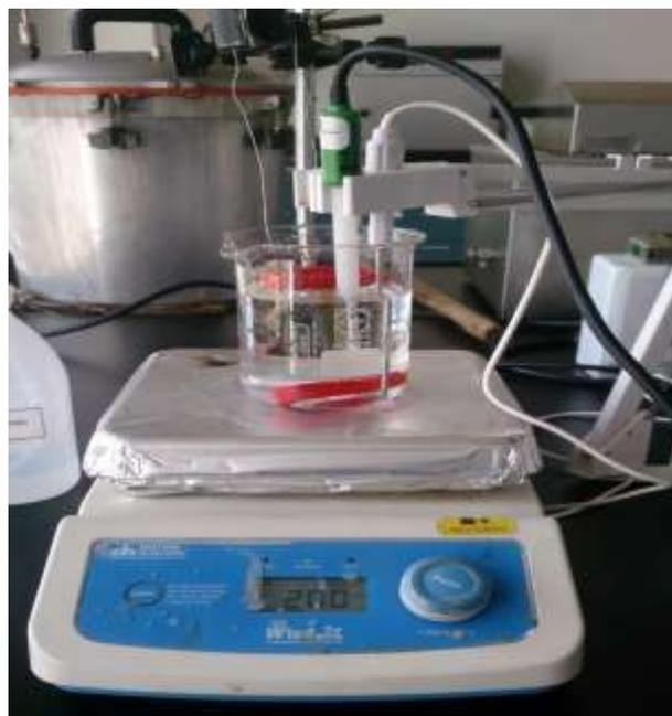
Figura H2: Montaje experimental selectividad por peso molecular mediante el uso de membranas de diálisis.
