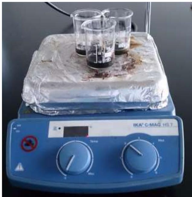
Figura H4: Montaje experimental tratamiento con resina catiónica fuerte en operación batch
