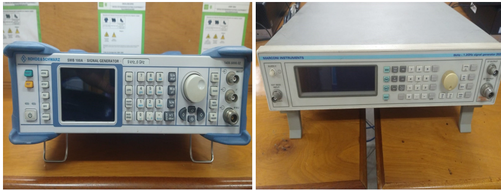
(a) Generador de señales R&S SMB100A. (b) Generador de señales Marconi Instruments IFR Aeroflex 2023.
