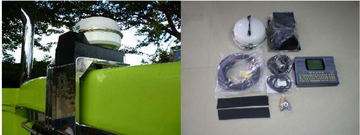
Figura 21. Registro fotográfico instalación unidades OmniTRACS
