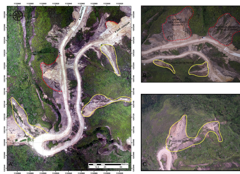
Figura 2. Imagen aérea del sector uno con identificación de eventos morfodinámicos (deslizamientos delineados en rojo y flujo de detritos delineados en amarillo).
