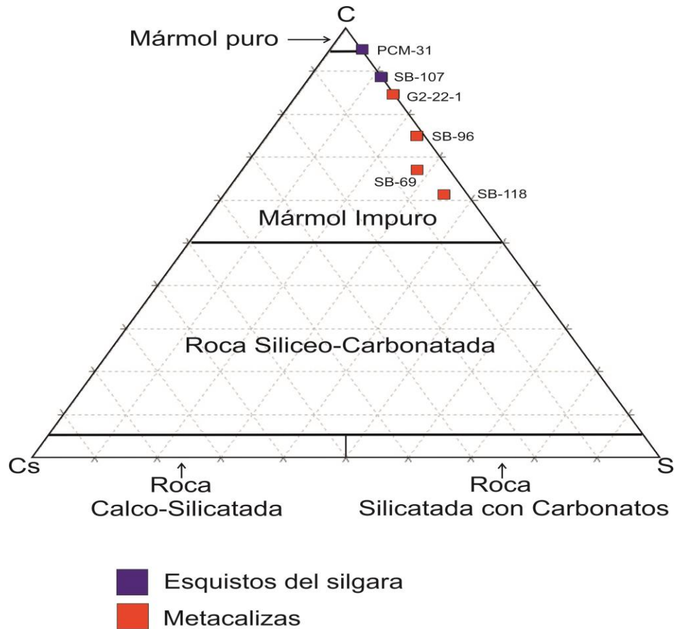
Figura 20. Triangulo de clasificación de rocas carbonatadas
