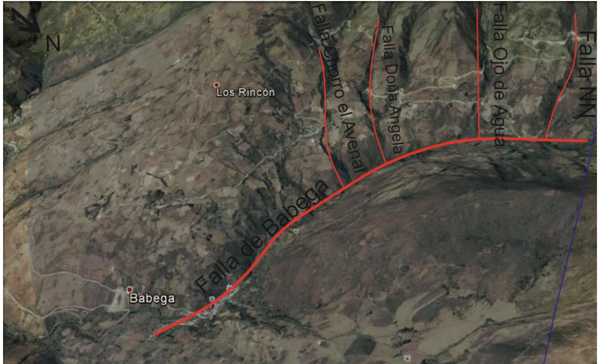
Figura 34. Trazo de las fallas paralelas Y semiparalelas entre sí las cuales son resultado de la Falla de Babega, alineadas con drenajes cortos y rectilíneos. Imagen lansat
