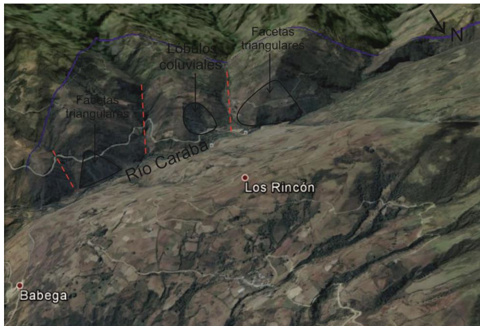
Figura 35. Evidencia de la Falla del Río Caraba, Y de color rojo se muestran el sistema de fallas NW-SE.
