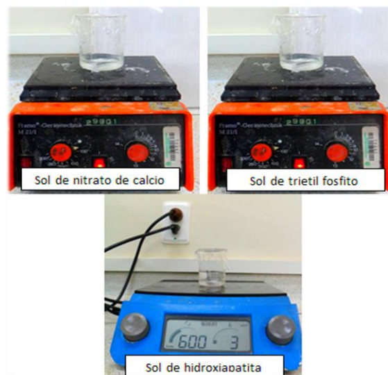
Figura 7. Montaje experimental del sol-gel de hidroxiapatita.
