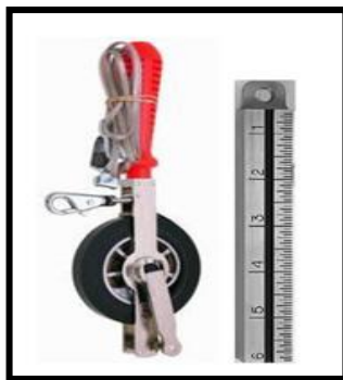
Figura 1. Cinta de medición a vacío.
