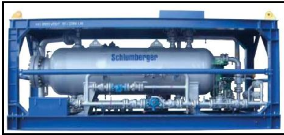
Figura 55. Servicio del Separador de Prueba para el Well Testing.
