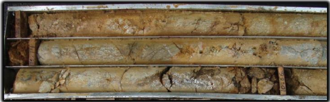
Fotografía 23. Zona de falla, rica en minerales como caolinita y arcillas.
