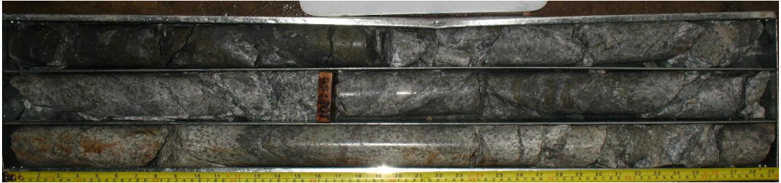
Fotografía 35. Zona de falla que afecta la calidad de la roca.
