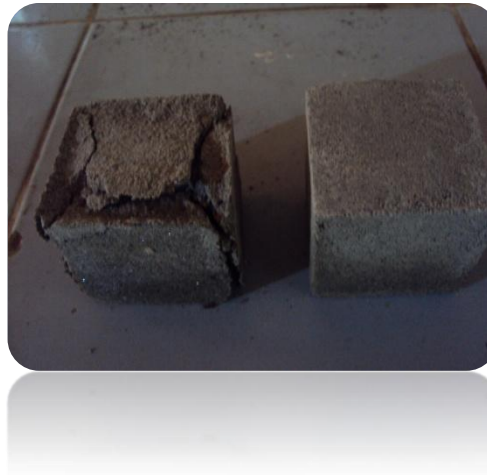
Figura 19. Probetas sometidas a la prueba de resistencia a la compresión
