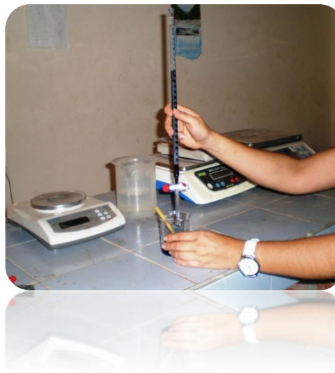
Figura 10. Desarrollo de la prueba de Azul de Metileno
