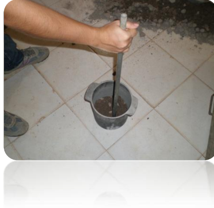
Figura 11. Desarrollo de la prueba de peso unitario y porcentaje de vacíos
