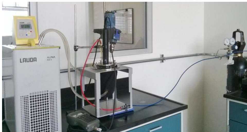
Figura 6. Montaje de la unidad de seguimiento por turbidimetría
