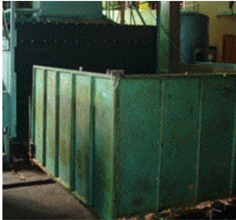
Figura 19. Vagón de cargue y transporte de los bloques de espuma a la máquina.
