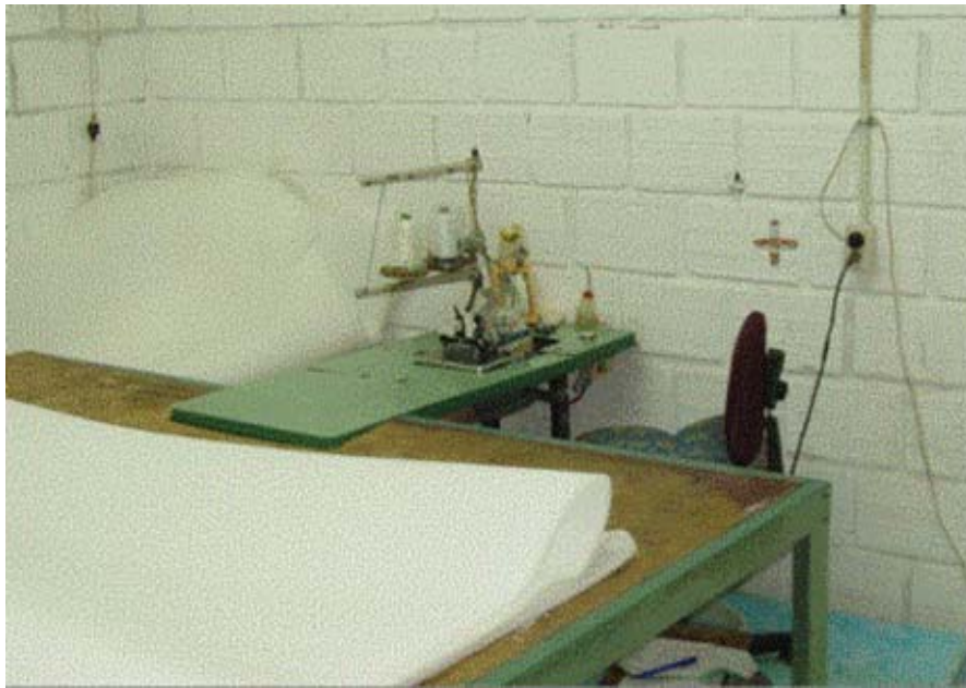
Figura 12. Fileteadora para costura de láminas espuma densidad 12kg/m.
