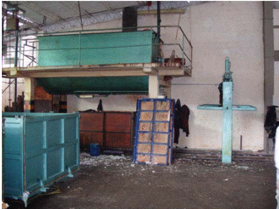
Figura 8. Prensa Hidráulica, vagones y tanque mezclador del adhesivo químico.
