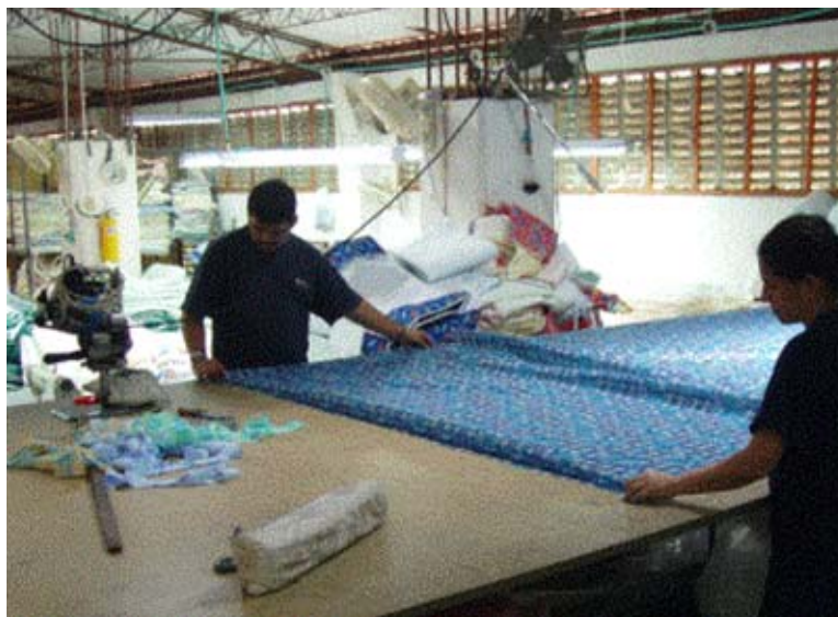
Figura 17. Mesa de corte tela, cortadora móvil al lado izquierdo figura.
