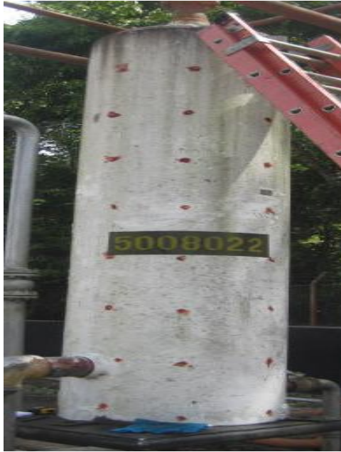
Figura. 6 Muestra la forma en la que se tomaron los puntos para la toma de espesores.
