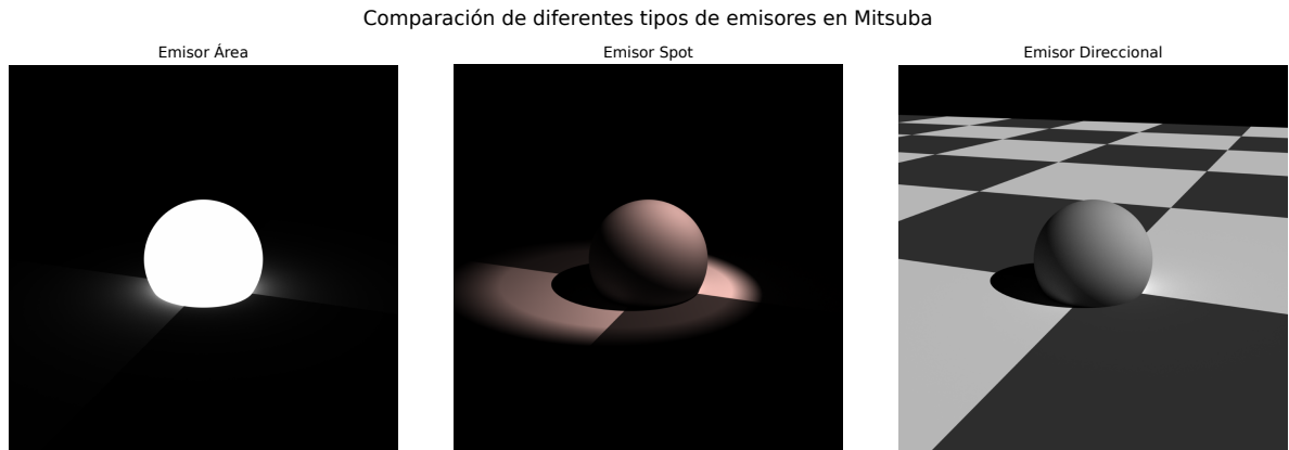
Figura 9. Ejemplo de emisor tipo area (izquierda), spot (centro) y directional (derecha). Imagen creada por los autores.
