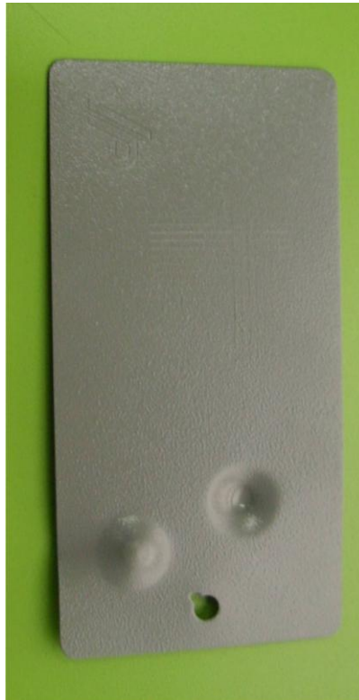
Figura 68. Prueba impacto y rayado
