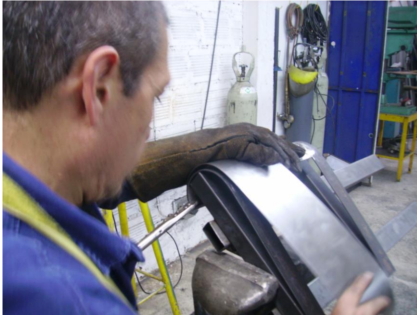
Figura 71. Rolado de lámina para módulos de armario.
