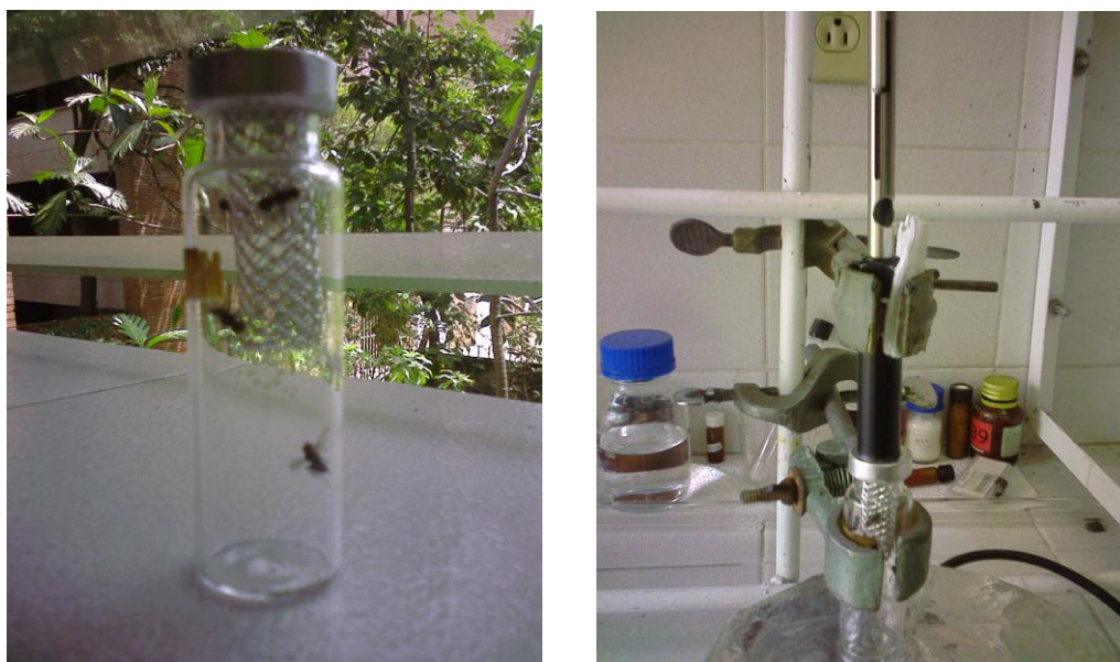
Figura 12. Muestreo in vivo de insectos de M. viatrix por medio de la técnica SPME, utilizando una fibra con recubrimiento de PDMS de 65 µm. Fuente: Los autores del presente proyecto.
