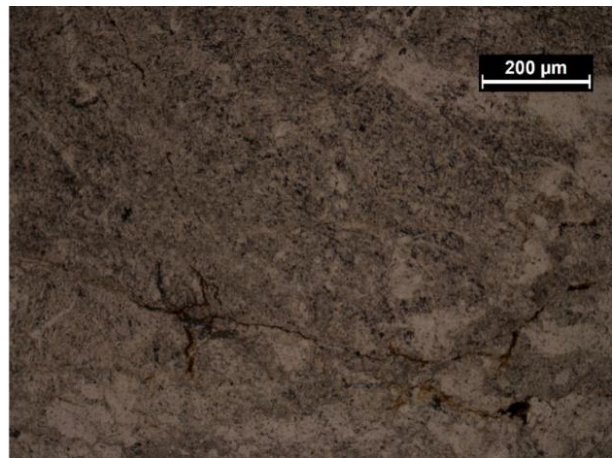
Figura 12. Microfotografía en nicoles paralelos y cruzados donde se observa la intensidad de la alteración cuarz-sericita. Se observan cuarzos de diferente tamaño asociados principalmente con sericita y algunos óxidos que se asocian con micro-fracturas.
