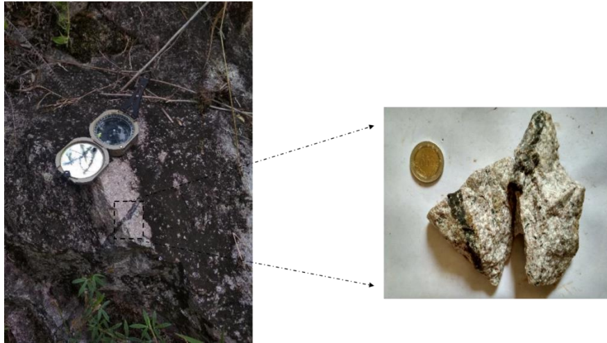
Figura 10. Fotografía donde se evidencia cuarzo calcedónico. Leucogranito de grano medio, con presencia de epidotización diseminada cortado por venas de cuarzo calcedónico (color negro).
