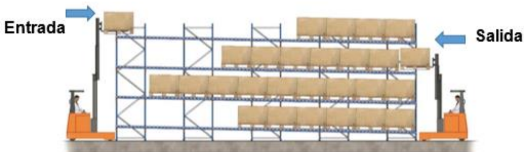
Ilustración 8. Funcionamiento del sistema de estanterías dinámicas con rodillos.
