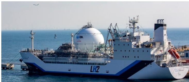
Figura 22. Suiso Frontier – Buque de hidrógeno líquido ( H_2L ).
