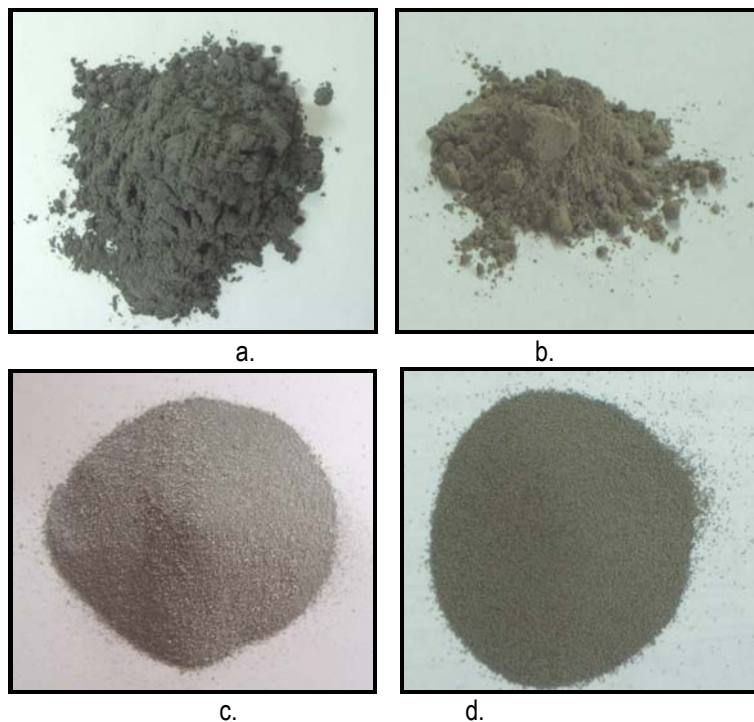
Figura 13. Macrografías de polvos de: a. titanio, b. plata, c. Aluminio, d. Níquel
