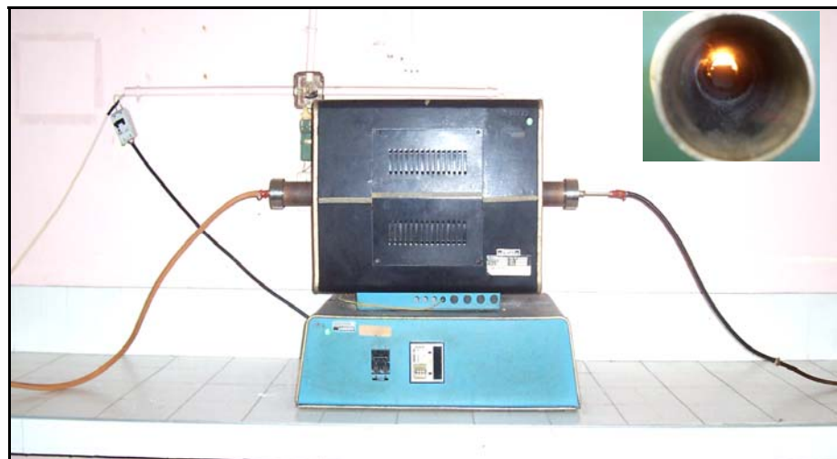
Figura 10 a. Fotografía del horno tubular de zonas marca Lindberg a. Detalle del interior del tubo.
