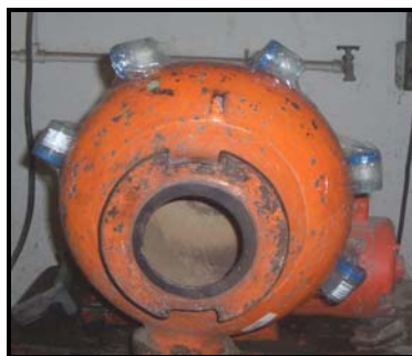
Figura 7. Molino de Bolas adaptado para el proceso
