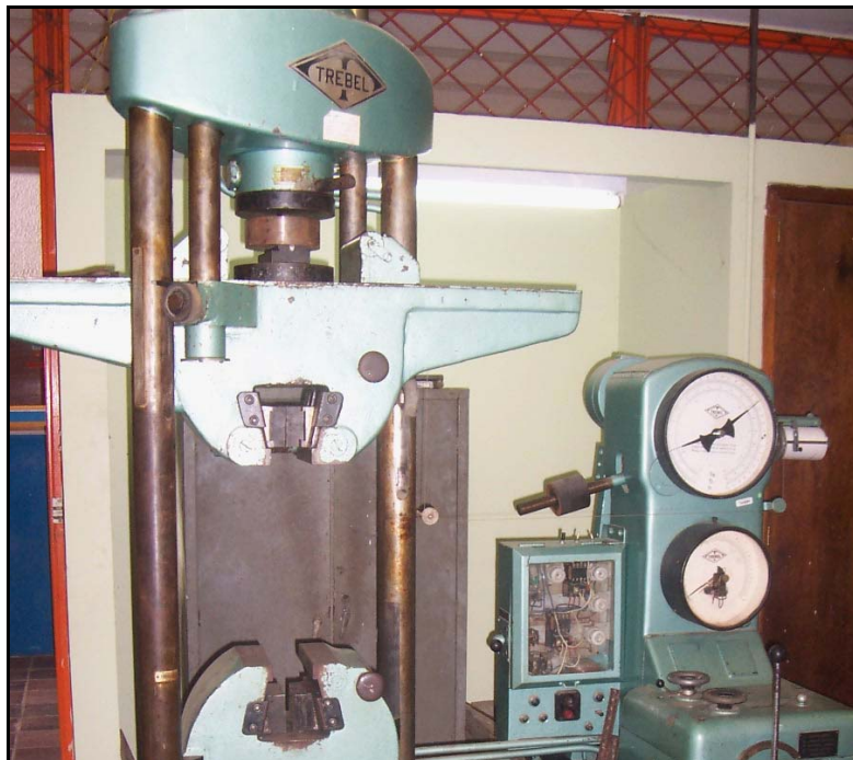
Figura 9. Fotografía de la maquina universal de ensayos marca Trebel
