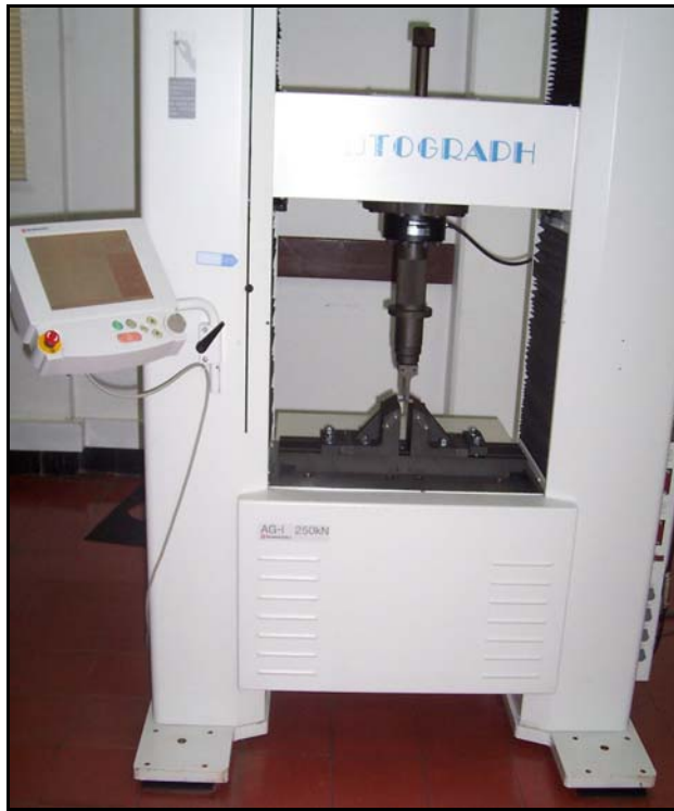
Figura 12. a. Fotografía del equipo universal de ensayos mecánicos marca AUTOGRAPH AG-I b. Detalle del montaje de la celda.
