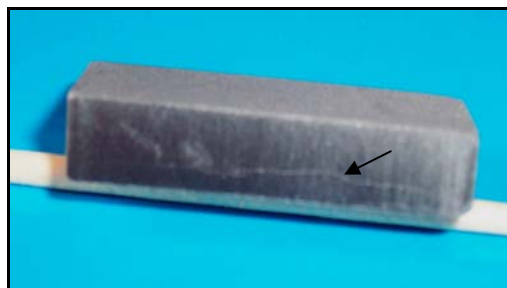
Figura 18. Grieta longitudinal presente en algunos compactos en verde
