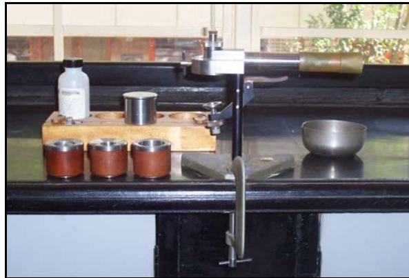
Figura 11. Fotografía del porosímetro Ruska
