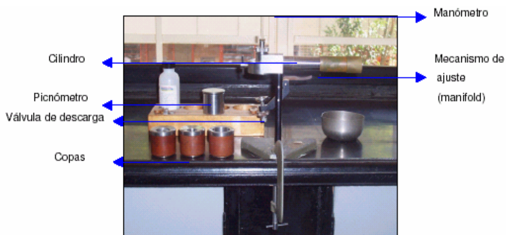
Figura 42. Anexo A. Partes porosímetro Ruska
