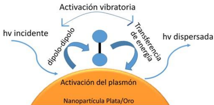
Figura 3. Activación de la RPS de la molécula al interactuar con la luz incidente. Adaptado de Schwartzberg AM, Zhang JZ. Surface-Enhanced Raman Scattering ( SERS ). In: Encyclopedia of Nanoscience and Nanotechnology . ; 2006:16-18. doi:10.1081/E-ENN-120024605
