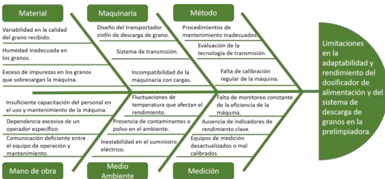
Figura 2. Diagrama Ishikawa, espina de pescado de las condiciones del diseño actual
