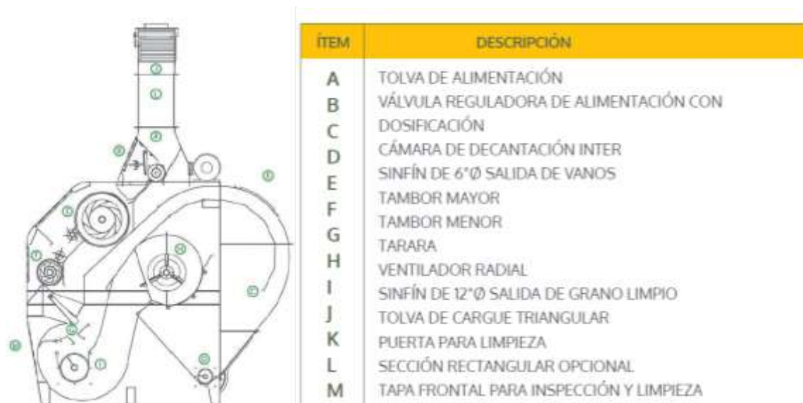
Figura 1. Prelimpiadora tipo Scalpert de circuito de aire cerrado, partes internas del equipo.
