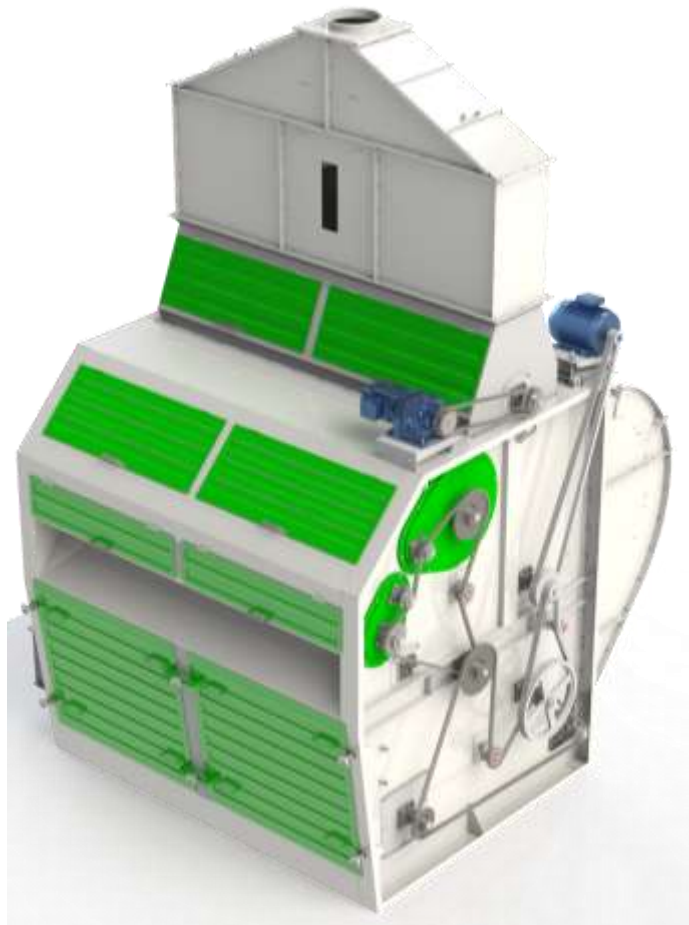
Figura 30. Render del rediseño de la prelimpiadora.
