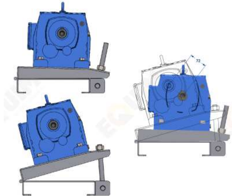
Figura 23. Sistema tensor diseñado para el motorreductor.
