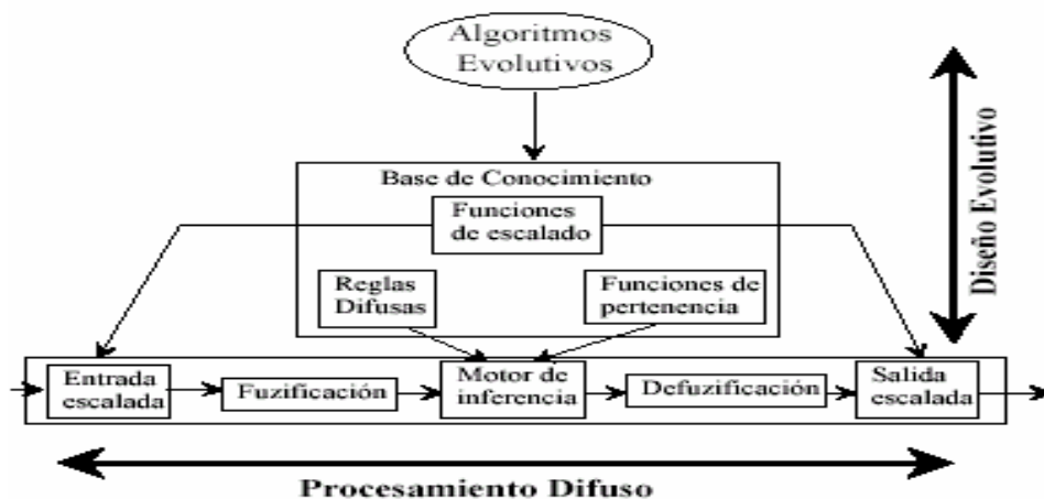
Figura 21 Diseño de un Sistema Genético Borroso.
