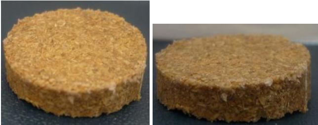
Foto 18. Muestras de aglomerados con cascarilla de arroz pulverizada
