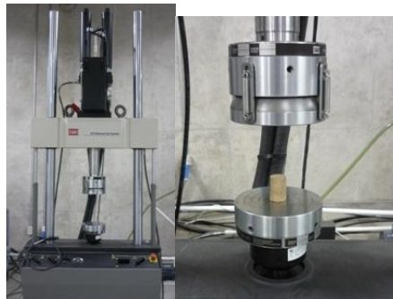
Foto 27. Equipo para compresión y flexión
