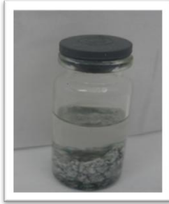
Foto 6. Dispersión de ABS post-consumo en Acetona.
