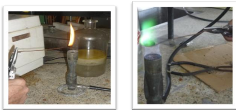
Foto 5. Comparación de polímeros ABS post-consumo vs PVC
