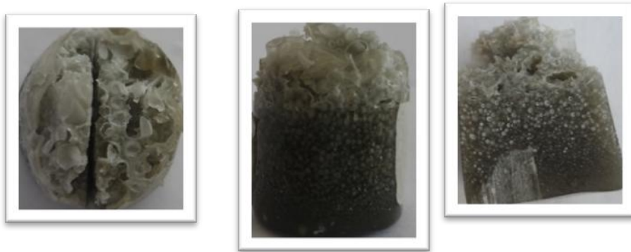
Foto 14. Fraguado y corte transversal muestras con exceso de agente disperso
