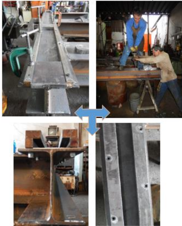
Figura 75. Proceso de construcción del riel del cilindro principal.
