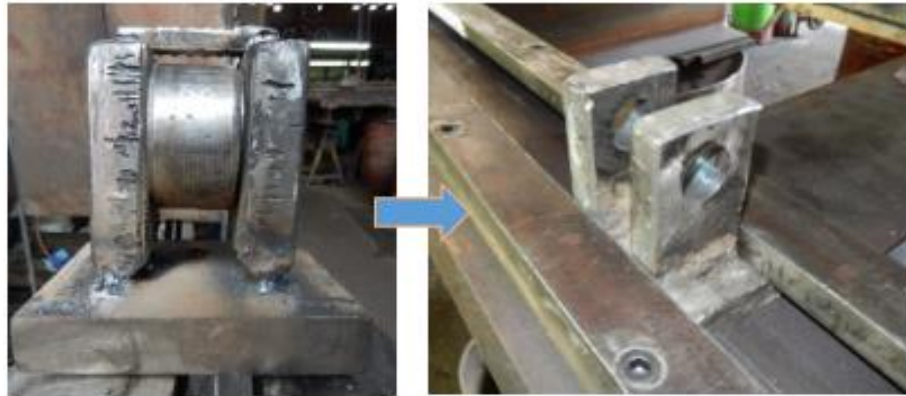
Figura 78. Proceso de construcción de la horquilla.
