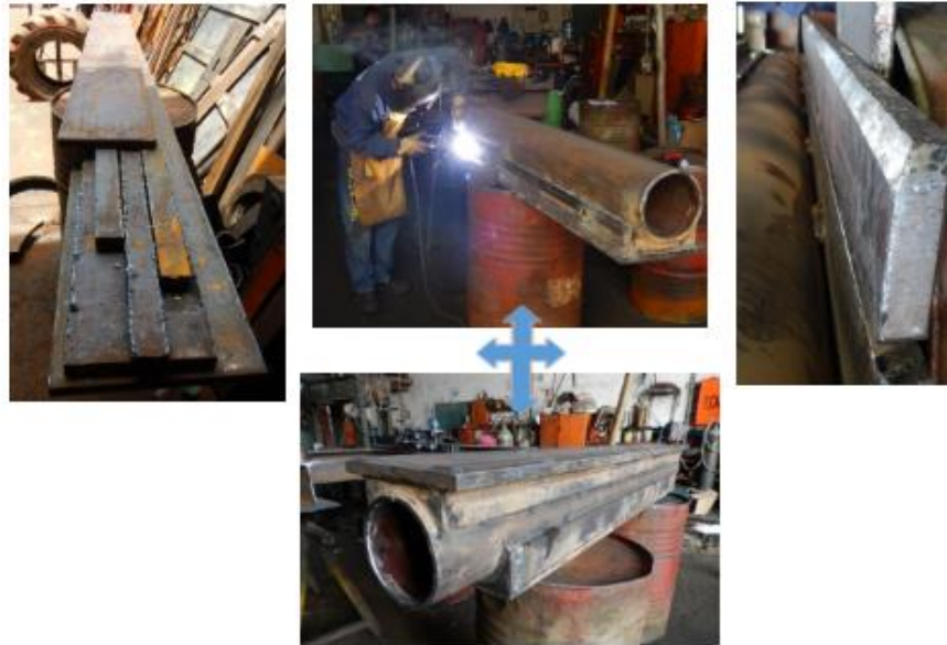
Figura 74. Proceso de construcción de la bancada del bastidor.
