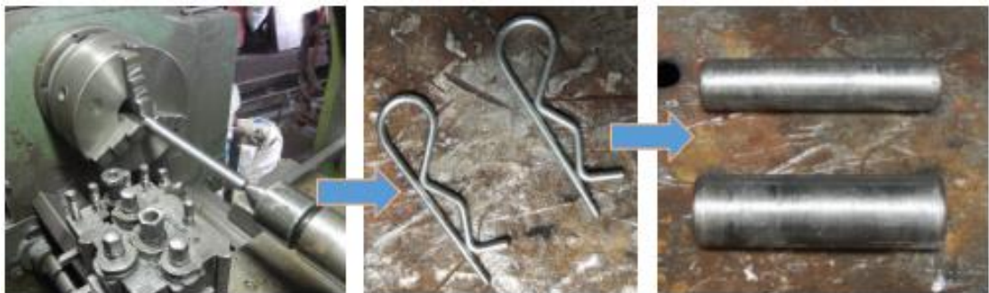
Figura 79. Proceso de construcción de los pasadores.
