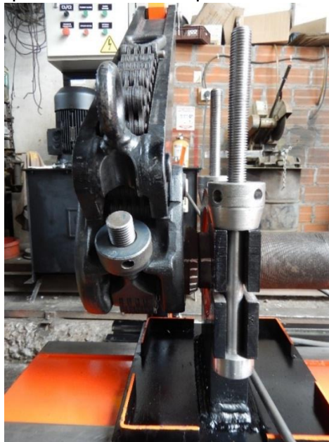
Figura 86. Fijación de las piezas antes de la operación
