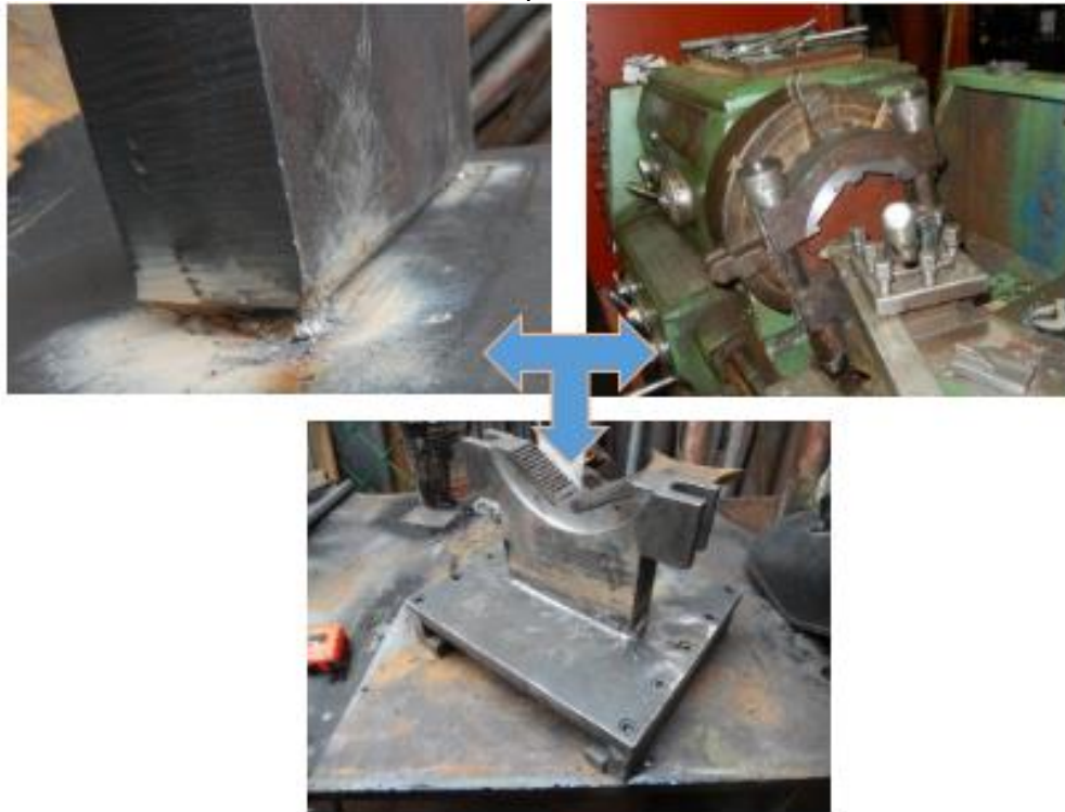
Figura 77. Proceso de construcción del soporte de mordazas.
