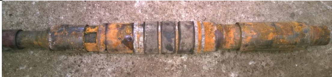
Figura 1. Packer hidráulico en condiciones de deterioro.
