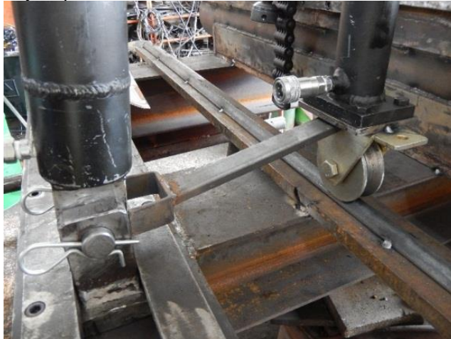
Figura 81. Patín, riel y separador del cilindro secundario.
