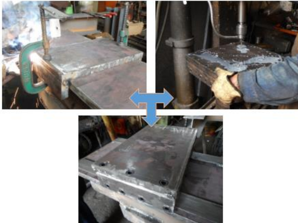
Figura 76. Proceso de construcción de las bases de los soportes.
