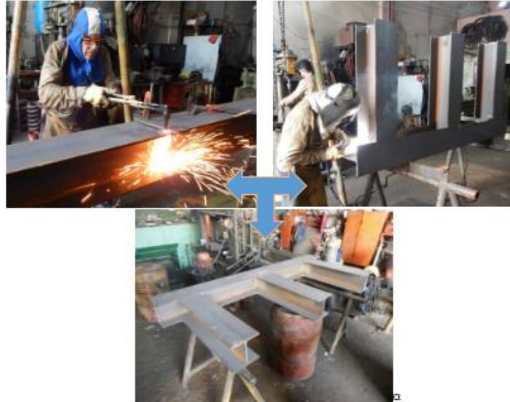
Figura 73. Proceso de construcción de la estructura base del bastidor.
