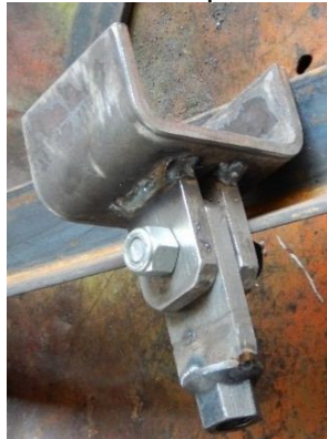
Figura 80. Soporte del cilindro de secundario para la llave de cadena.
