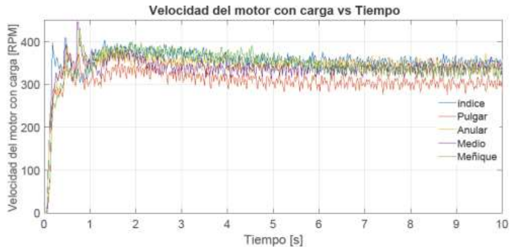
Figura 13. Velocidad de los motores con carga en el eje.
