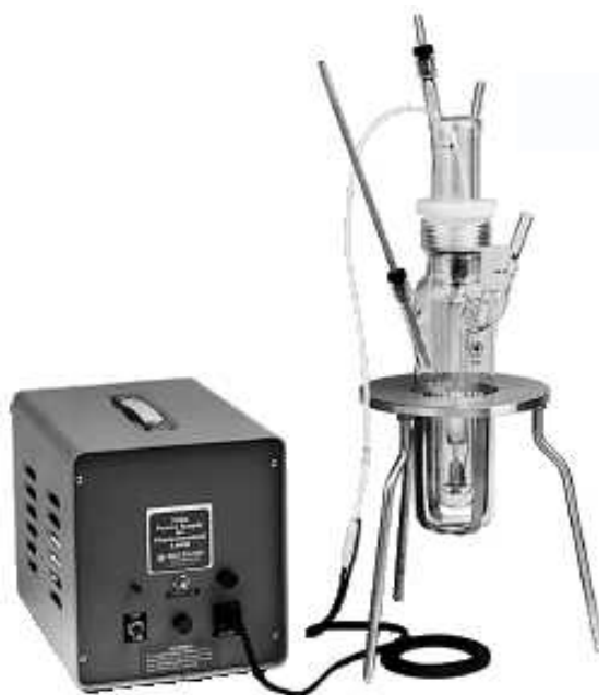
Figura 5. Reactor para la fotodeposición de platino sobre la superficie de TiO 2 y fotooxidación de metano.
