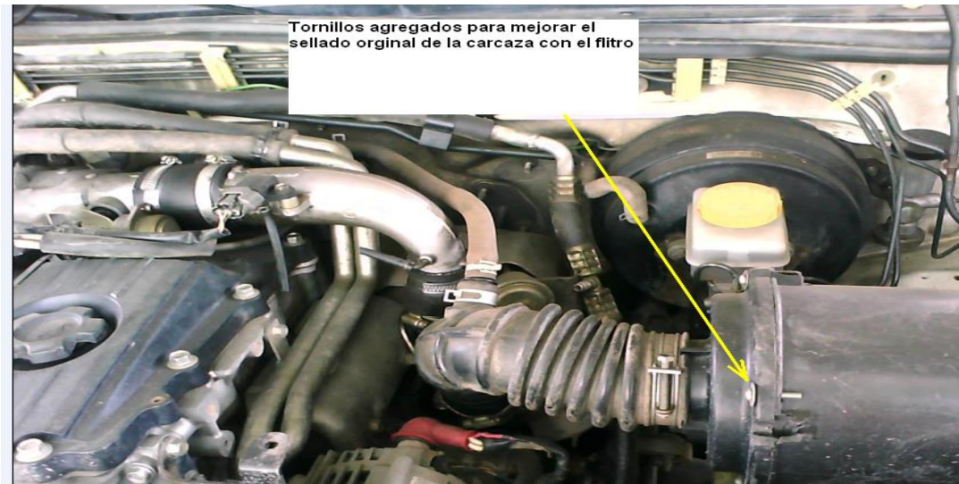
Figura 23. Vista de carcasa de filtro de aire
