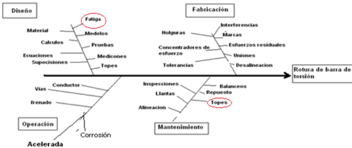
Figura 31. Diagrama causas – efecto para análisis de rotura del chasis
