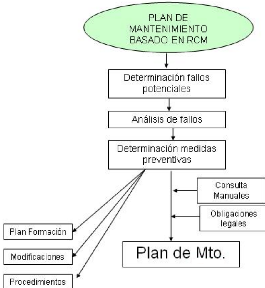
Figura 6. Esquema RCM para elaborar un plan de mantenimiento
