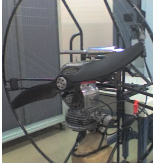
Figura 78. Montaje de la hélice a copiar en el banco de pruebas
