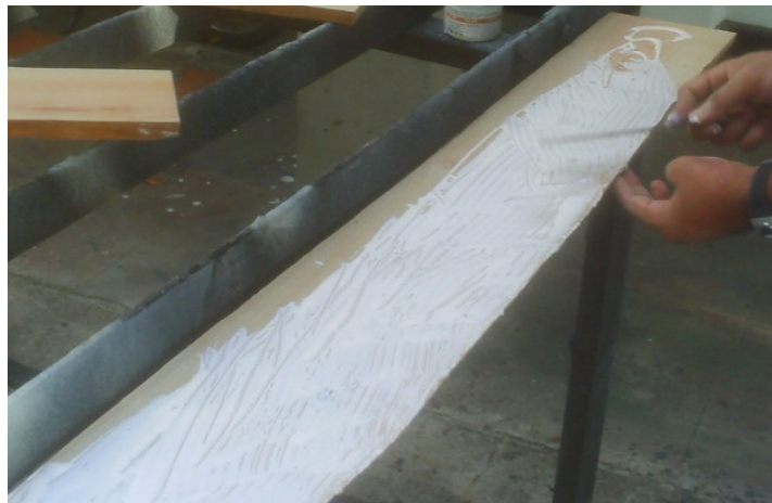
Figura 69. Aplicación de adhesivo
