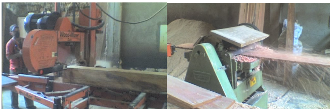
Figura 66. Procesos de corte y cepillado de madera
