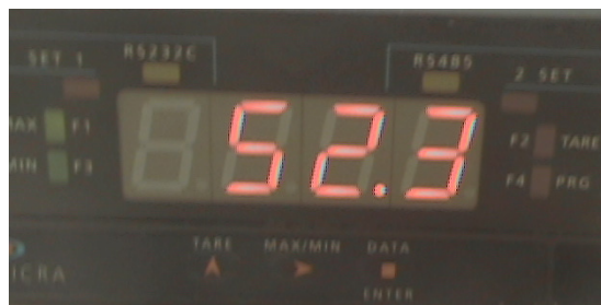
Figura 79. Medida de empuje de la hélice 1
