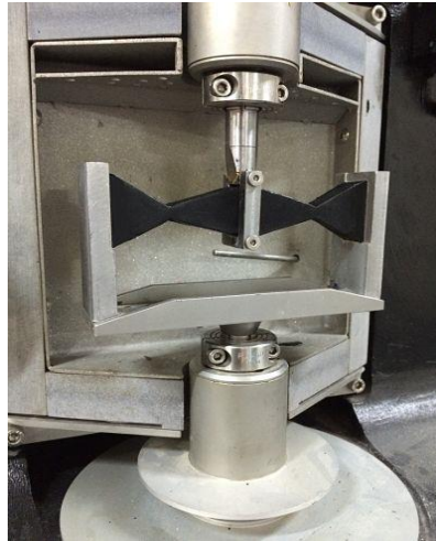
Figura 4. Montaje de las piezas móvil y fija con la probeta experimental
