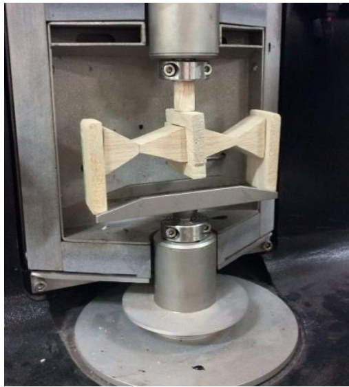
Figura 15. Prototipos de las piezas adaptables y probeta a la Metravib DMA+1000
