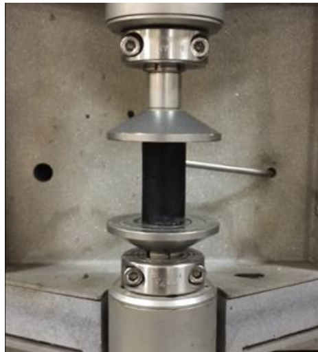
Figura 18. Montaje de los cilindros
