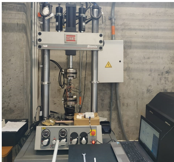
Figura 31. Prueba de tracción para aros sensores de tensión.
