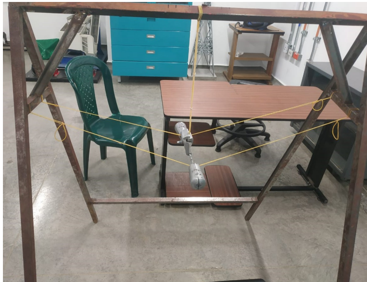
Figura 36. Amortiguador Stockbridge suspendido libremente.
