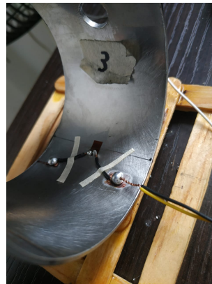
(d) soldadura y coneccion de puente de Wheastone.
