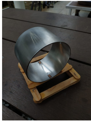
(a) lijado, limpieza del aro y marcación de la posición de la galga.
