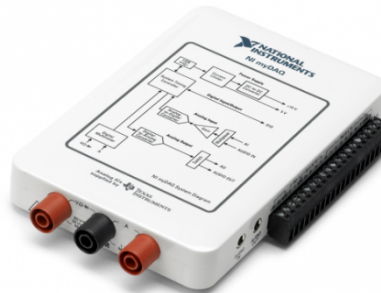
Figura 28. Dispositivo de adquisicion de datos NI-myDAQ.
