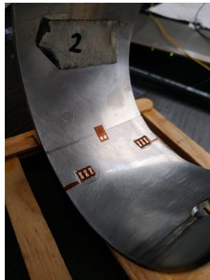
(a) lijado, limpieza del aro y marcación de la posición de la galga.
