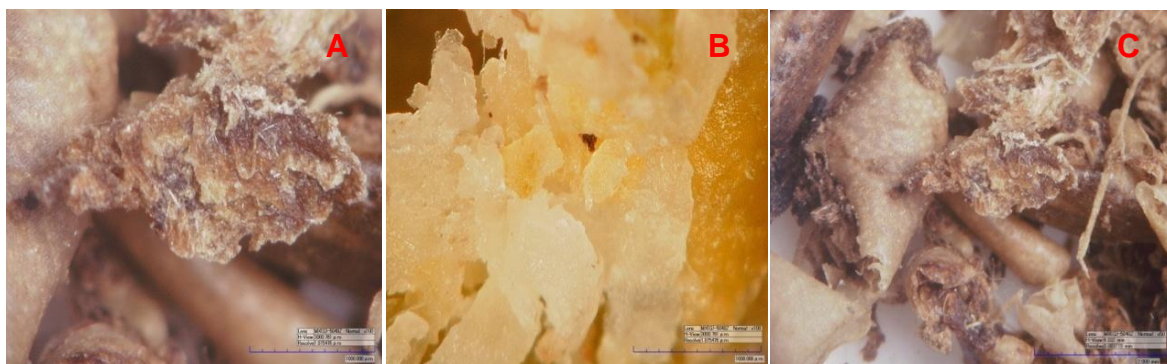
Figura 5. Micrografías del BF. A: BF sin tratar; B: PT químico; C: PT mecánico.
