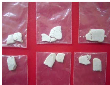
H4. Muestras poliméricas después del ataque químico
