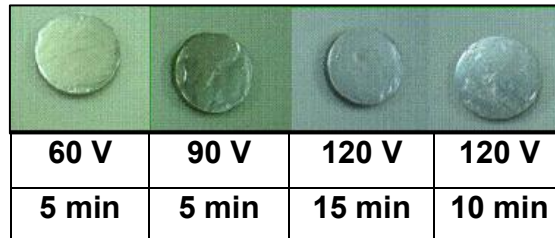
Figura 14. Probetas de Ti6Al4V recubiertas con el ácido poli (L-láctico) obtenido
