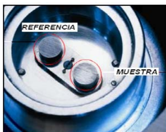
Figura J2. Celda del DSC Q10
