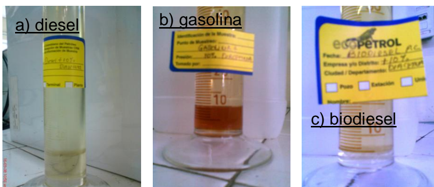
Figura 41. Fotografías pruebas de solubilidad de diacetina al 10%p en combustibles
