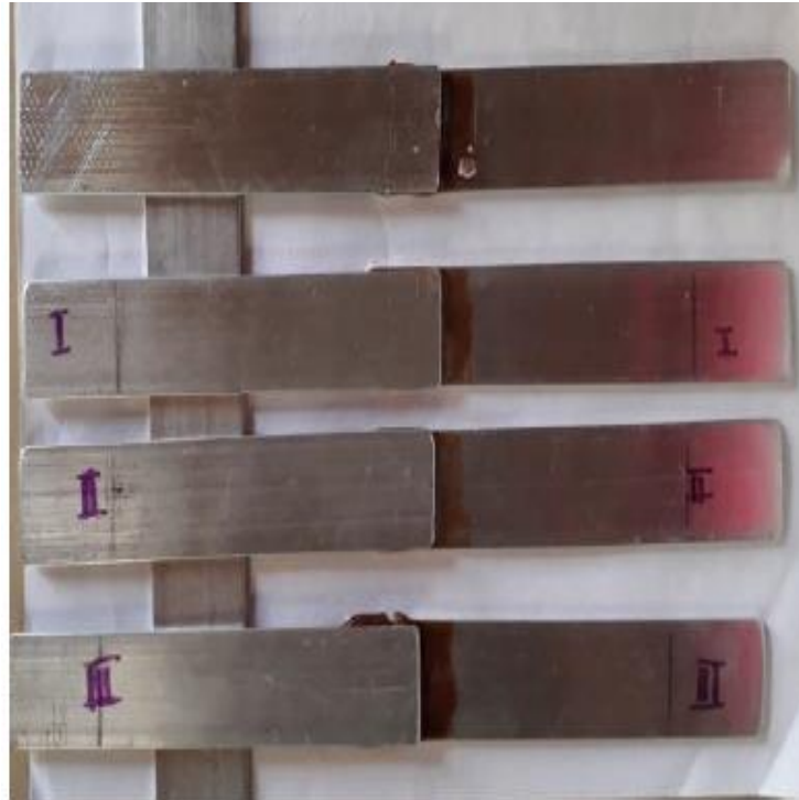
Figura 13 Juntas para ensayo de cizalladura
