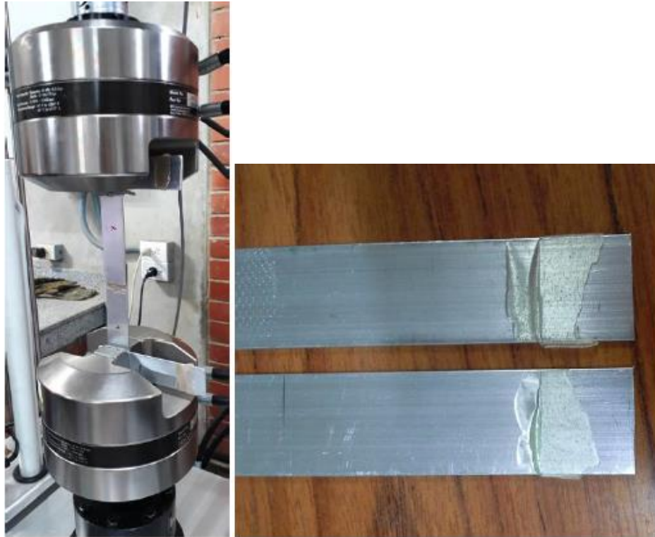
Figura 14 Montaje para las pruebas de cizalla y falla del adhesivo
