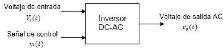
Figura 12. Modelo de subsistema para circuito inversor
