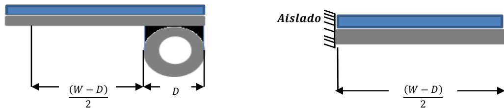
Figura 63. Analogía del módulo fotovoltaico-placa absorbidora con una aleta
