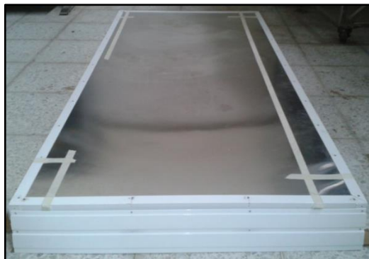
Figura 99. Marco externo de aluminio del captador solar
