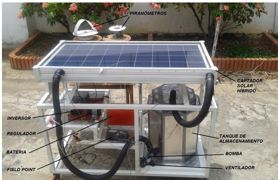
Figura 125. Prueba del colector solar híbrido (térmico y fotovoltaico)
