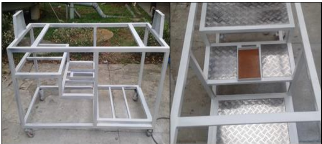
Figura 112. Estructura de sostenimiento pintada y bases de los elementos del colector.
