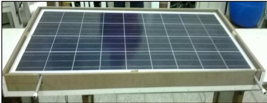
Figura 96. Montaje módulo fotovoltaico, placa absorbadora y marco interno de madera
