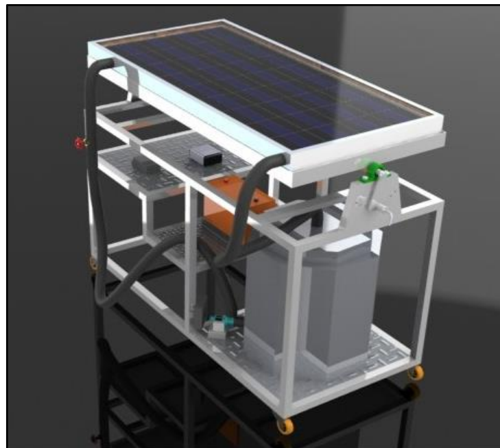
Figura 121. Montaje general del colector solar híbrido (térmico y fotovoltaico)
