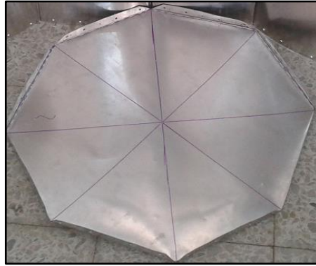
Figura 106. Proceso de elaboración de la cara inferior y prisma octogonal de la carcasa inferior del tanque.
