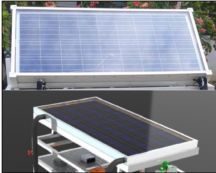
Figura 100. Captador del colector solar híbrido
