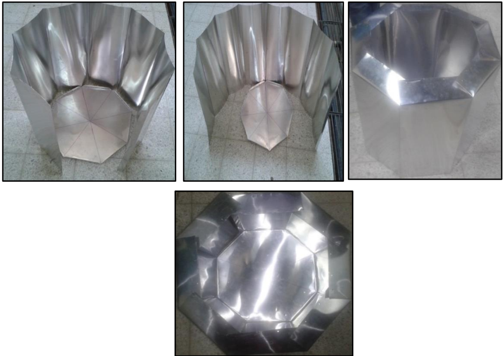
Figura 106. Proceso de elaboración de la cara inferior y prisma octogonal de la carcasa inferior del tanque.
