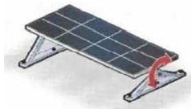
Figura 44: Generador con seguidor a un eje inclinado.
