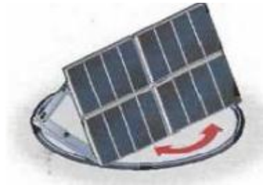
Figura 43: Generador con seguidor vertical.
