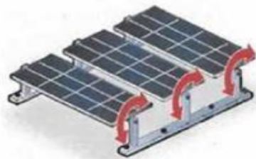
Figura 42: Generador con seguidor horizontal.
