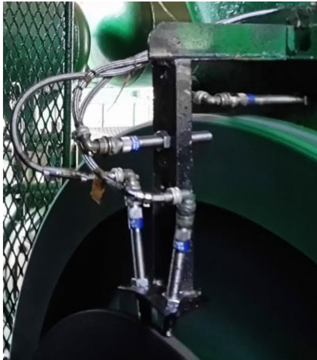
Figura 14. Sensor cuenta dientes, sensor efecto hall, sensor reset, arnes
