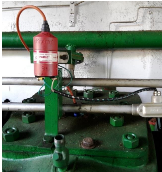
Figura 15. Transformador de ignición, cable primario, cable secundario y bujía
