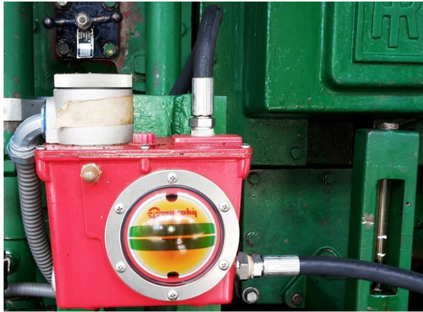
Figura 18. Switch de nivel de aceite marca Murphy modelo LMX-301
