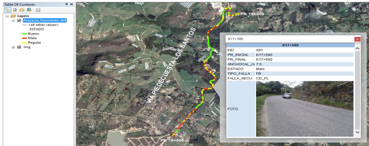
Figura 62. Visualización de la información del pavimento que contiene cada uno de los tramos de vía.
