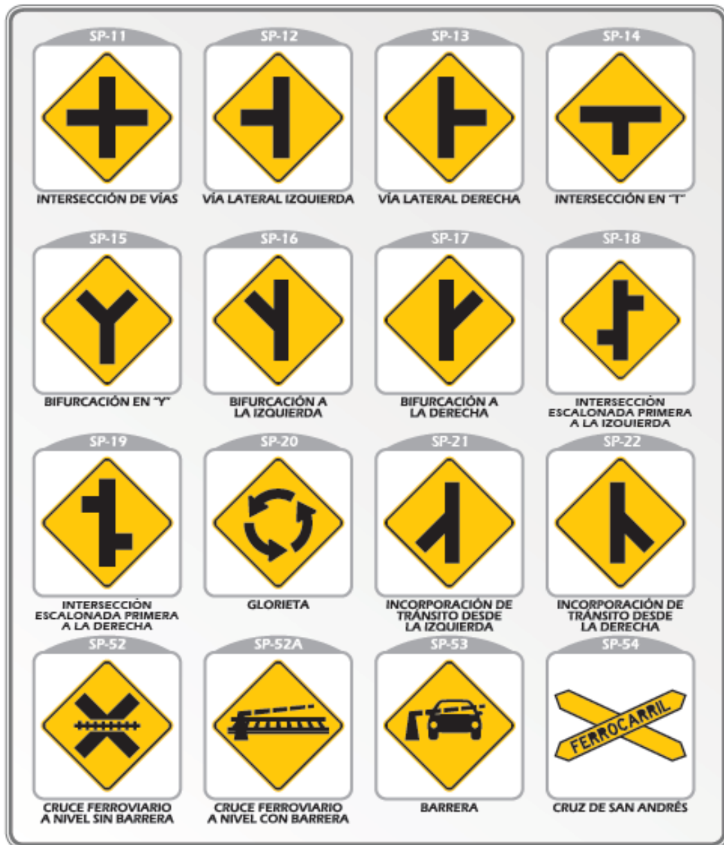
Figura 16. Señales preventivas de intersecciones con otras vías.
