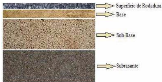
Figura 20. Estructura de un pavimento flexible.
