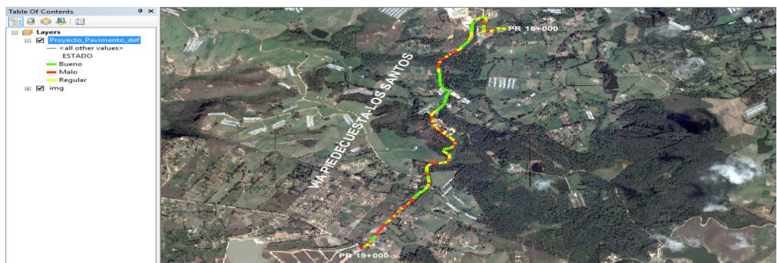
Figura 61. Visualización general del estado del pavimento en ArcGIS 10.2.
