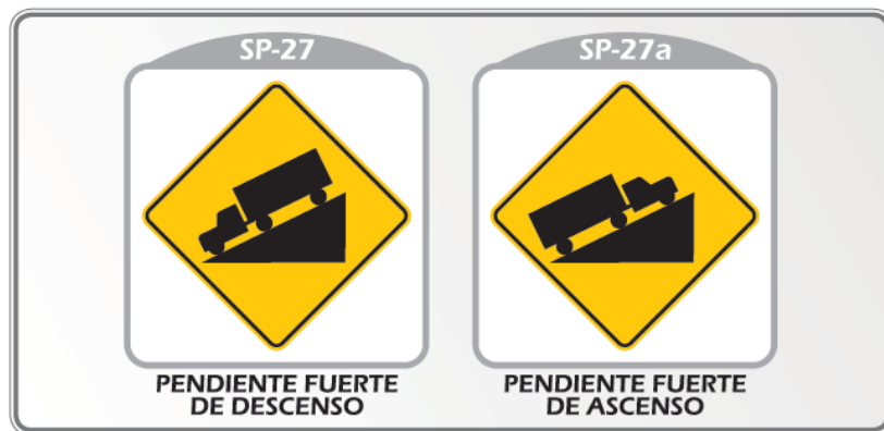
Figura 12. Señales preventivas relacionadas con la pendiente longitudinal.
