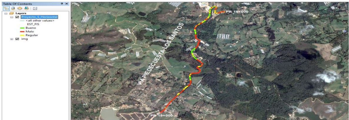
Figura 63. Visualización general del estado de la señalización horizontal en ArcGIS 10.2.
