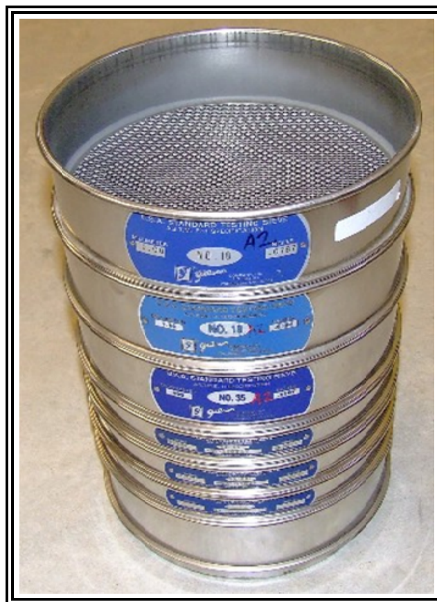
Figura 3: Tamices Utilizados para la determinación de la Granulometría.
