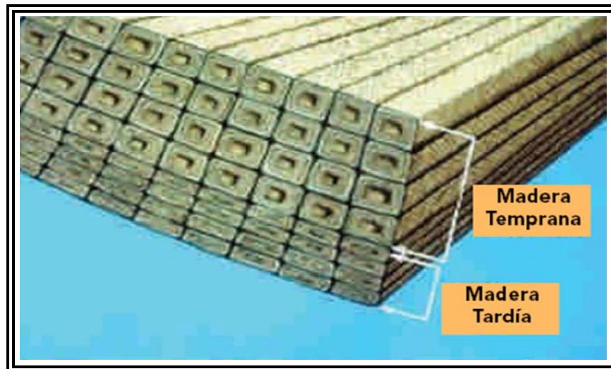
Figura 95: Vista detallada de la Madera temprana y Madera tardía.
