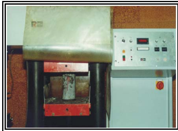
Figura 73: Ensayo de cilindro de concreto
