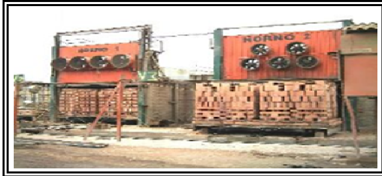
Figura 130: Cocción del ladrillo
