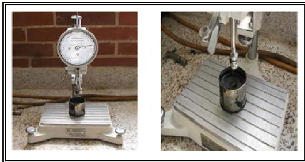
Figura 61: Ensayo de Penetración
