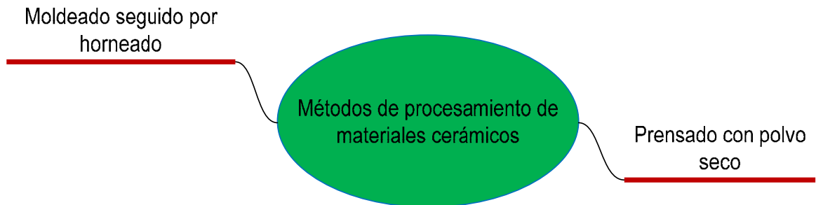
Figura 124: Métodos de procesamiento de Materiales Cerámicos
