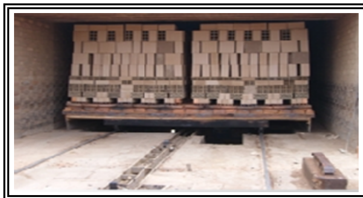
Figura 129: Secado del ladrillo
