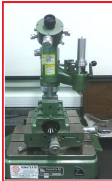
Figura 7: Microdurómetro Zwick con indentador piramidal de base cuadrada.
