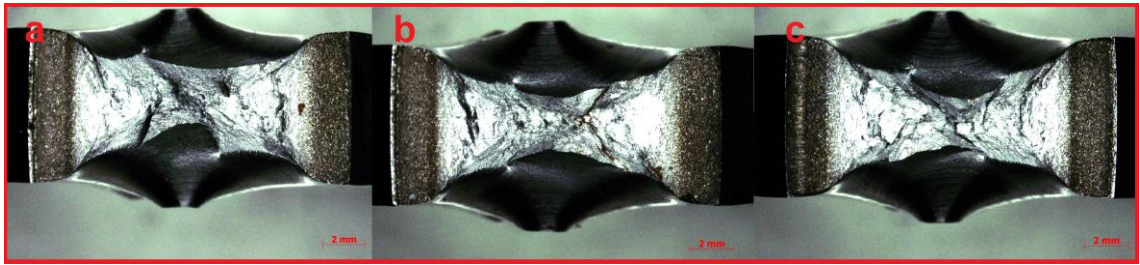
Figura 39: Fractura a -80°C. a) 7,5 J. b) 8,75 J. c) 13,75 J.
