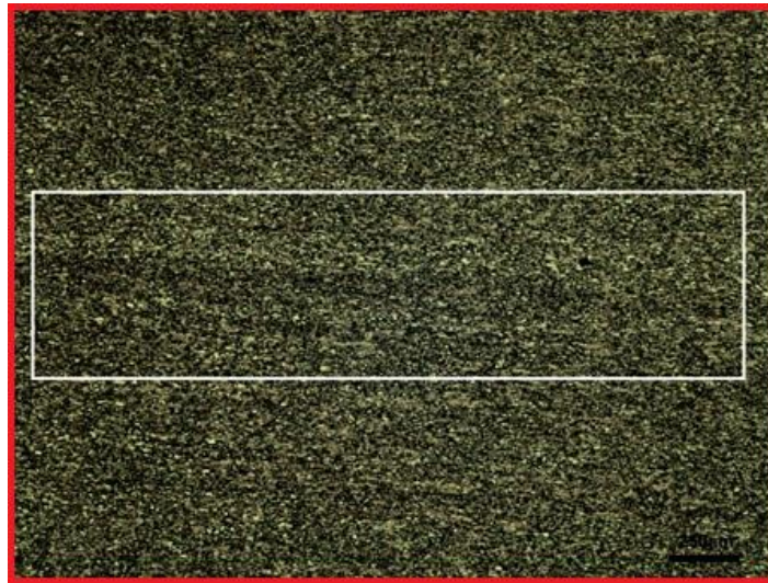
Figura 30: Línea central de segregación. 500X.
