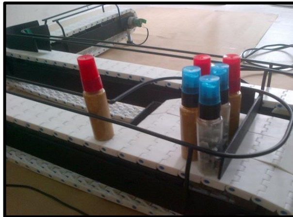
Figura 198. Funcionamiento óptimo de la mesa de acumulación
