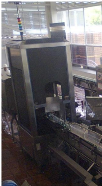
Figura 30. Inspectores automáticos (“OmniVision II Inspección de botella vacía”)
