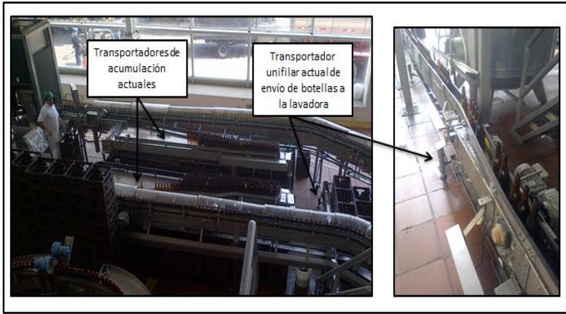
Figura 165. Transportadores reutilizables para el nuevo diseño
