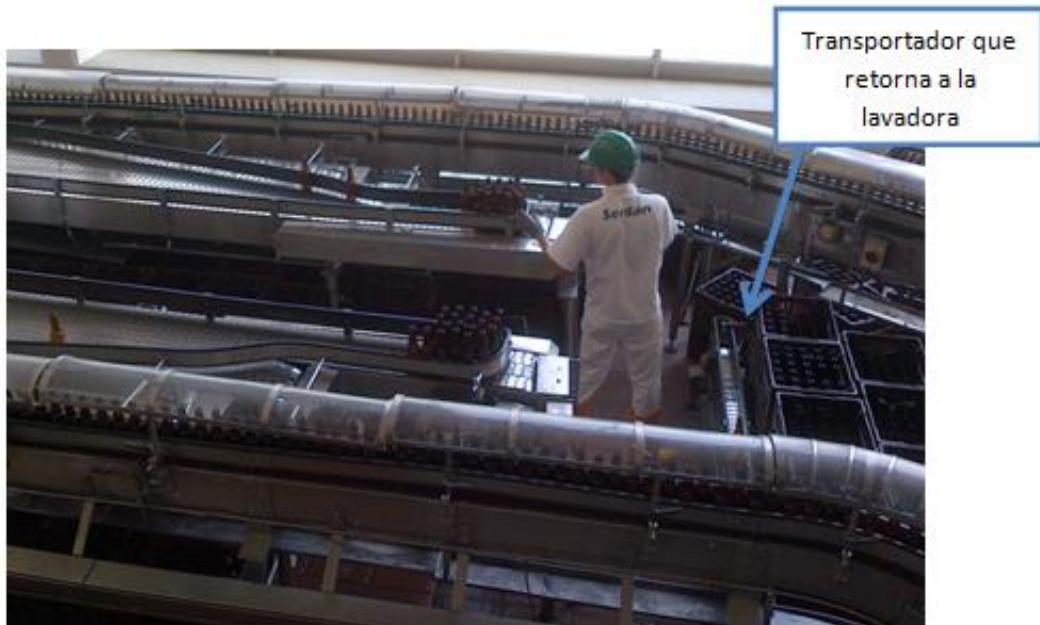
Figura 6. Línea de retorno a la lavadora.
