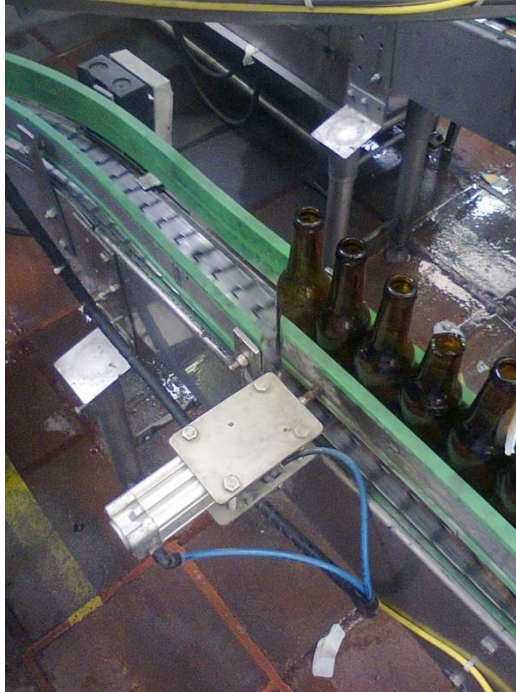
Figura 135. Estancamiento de botellas mediante la electroválvula
