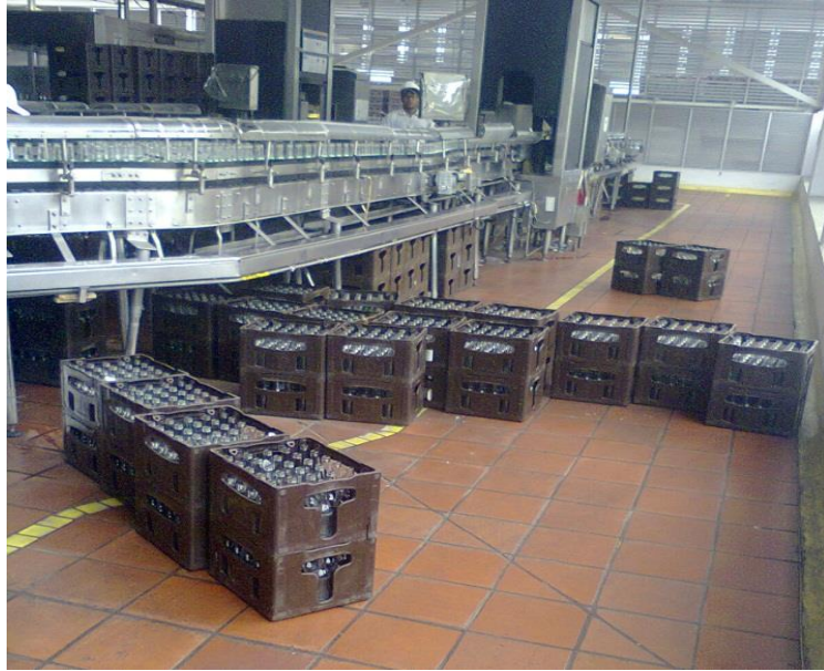
Figura 34. Expulsión y desorden de cajas
