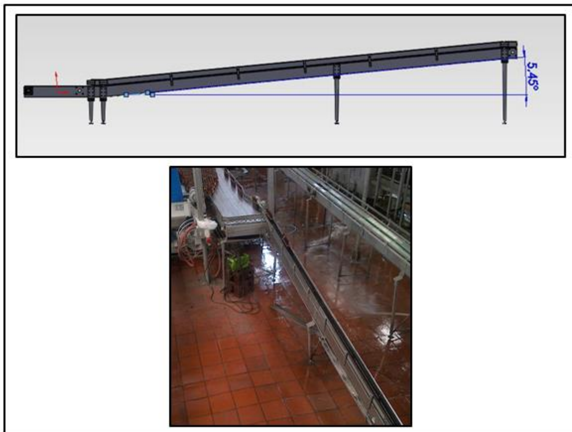
Figura 162. Ángulo de entrada al transportador de la planta que se dirige a la lavadora
