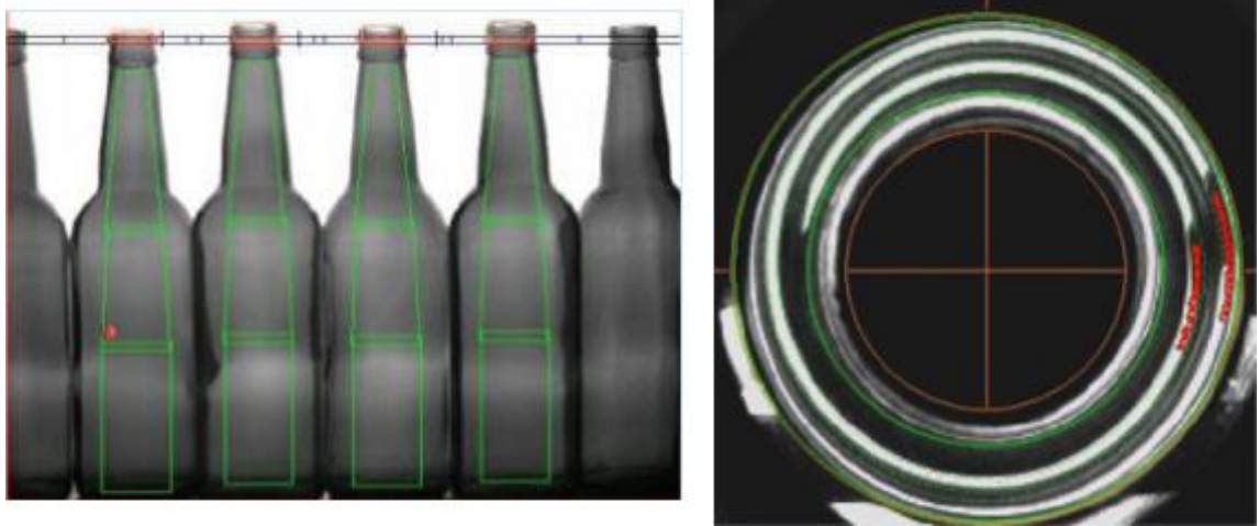
Figura 5. Inspección de la cámara
