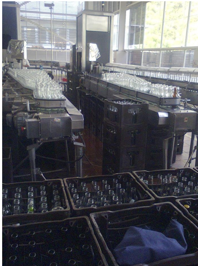
Figura 33. Zona de acumulación llena
