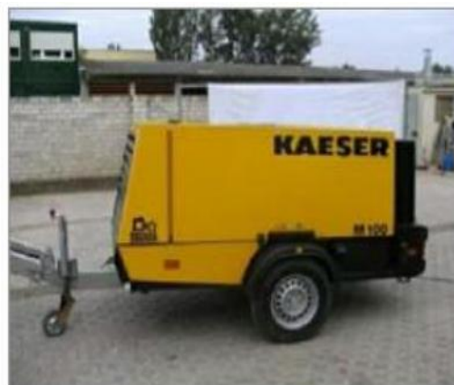
Figura 16. Compresor Kaeser 375 M100.
