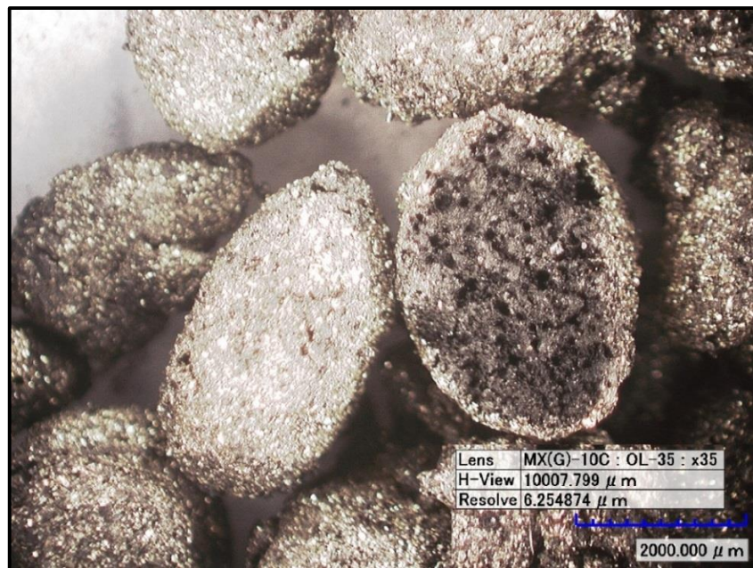
Figura 6. Micrografía de aglomerados cargados después de la etapa de contactación con microscopio HIRUX KH-7700.
