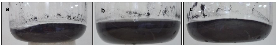
Anexo D. Fotografías de concentrados obtenidos mediante el uso del concentrador Knelson con una fuerza centrífuga de 60 veces la fuerza de gravedad, variando los niveles de flujo de agua. a) 3.5 L/min. b) 2.8 L/min. c) 2.0 L/min.
