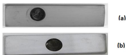
Figura 20. Fotografías de los cuerpos de prueba ensayados en la solución 1, después de realizado las pruebas de EIS. (a) Ensayo en el metal base, (b) Ensayo en la junta soldada. Fuente: Autor
