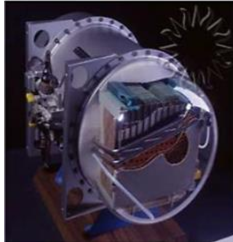
Figura 26. Pila de combustible de electrolito utilizada en los transbordadores modernos. Adaptado de Aguirre Guevara, O. A. (2013). Celdas de hidrogeno y su potencial de aplicación. Universidad Veracruzana, Xalapa.
