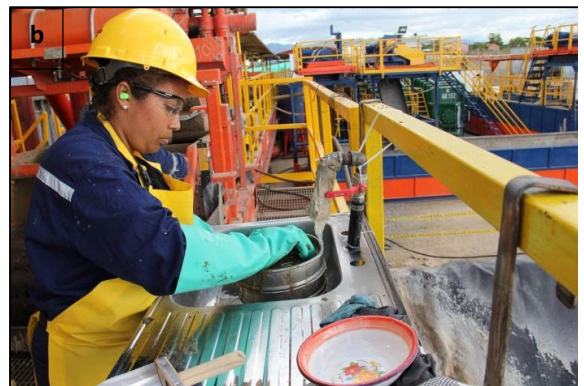
Figura 17. Proceso de recolección de muestras de ripios. a. Toma de muestra de la zaranda vibratoria. b. Lavado y tamizado de la muestra recuperada. c. Peso de la muestra de zanja. d. Secado de la muestra en el horno. e. Estudio fotográfico de muestras de zanja. f. Plantillas para fotografías de muestras de zanja. g. Bolsa de cierre hermético para la preservación de muestras de zanja. h. Almacenamiento de cajas. i. Unidad Mudlogging j. Laboratorio para análisis de muestras.k. Visualización de la master (Drill monitor) l. Cromatógrafo y pantalla de transmisión de datos en tiempo real.
