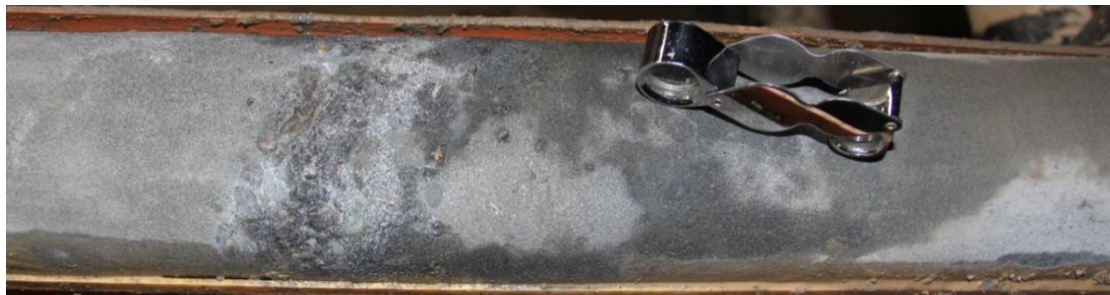
Figura 64. Arenisca de grano muy fino a medio en contacto con arenisca conglomerática.
