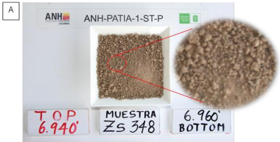
Figura 33. Fotografía de muestras de zanja correspondientes a la Formación Mosquera del intervalo de 6920´ a 7000´. Donde se muestra: A) Arcillolita parda, moderadamente firme menor blanda, algunas limosas, levemente calcárea.
