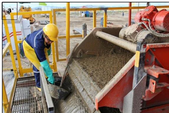
Figura 17. Proceso de recolección de muestras de ripios. a. Toma de muestra de la zaranda vibratoria. b. Lavado y tamizado de la muestra recuperada. c. Peso de la muestra de zanja. d. Secado de la muestra en el horno. e. Estudio fotográfico de muestras de zanja. f. Plantillas para fotografías de muestras de zanja. g. Bolsa de cierre hermético para la preservación de muestras de zanja. h. Almacenamiento de cajas. i. Unidad Mudlogging j. Laboratorio para análisis de muestras.k. Visualización de la master (Drill monitor) l. Cromatógrafo y pantalla de transmisión de datos en tiempo real.
