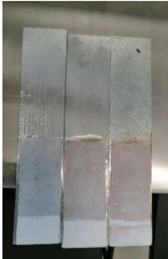
Figura 33. Unión entre adherente rígido y flexible (1%, 3% y 5%).
