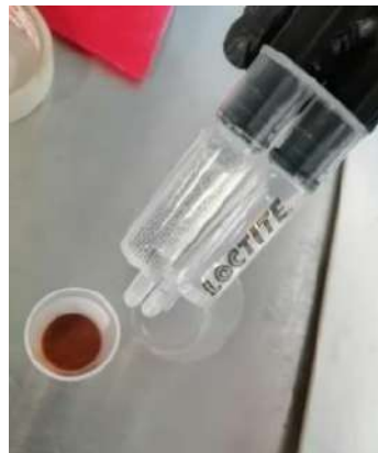
Figura 30. Mezcla de lignina con resina epoxica.
