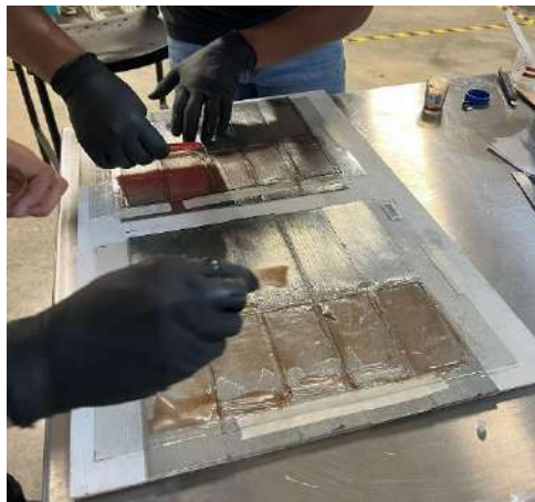
Figura 32. Preparación de adhesivo.
