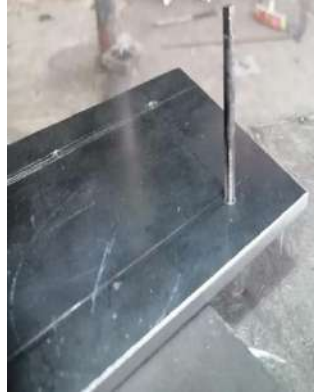
Figura 19. Roscado agujeros placa deslizante
