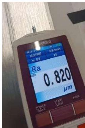
Figura 31. Toma de valores de rugosidad.
