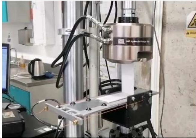
Figura 34. Prueba de pelado.
