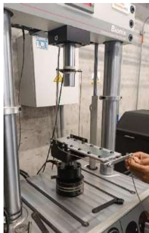
Figura 26. Máquina MTS BIONIX con accesorio de despegue.
