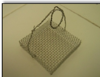
Figura 8. Canasta fabricada en acero inoxidable AISI 304.
